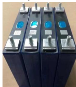
Figure 5. LifePo 12 Volt 100 Ah
